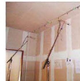
音響インテンシティ法による界壁遮音測定
