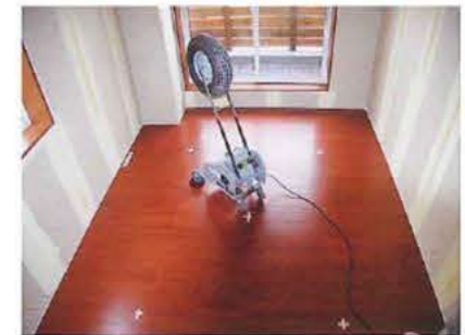
バグマシンによる重量床衝撃音波測定
